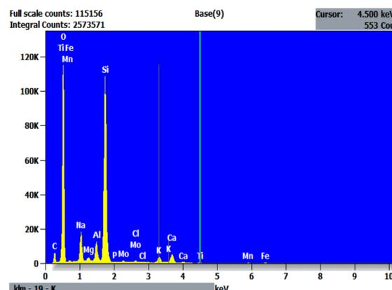
Fig. 6. HVA31 SEM-EDS spectrum
