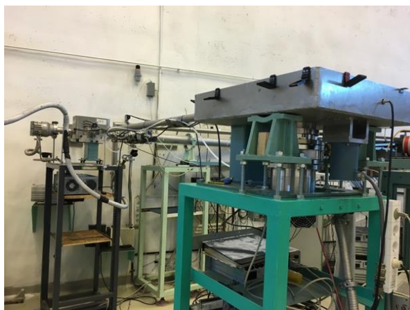
Foto 4. Sistemul de transport al radioactivității pentru experimente de dezintegrare beta în fond redus.
