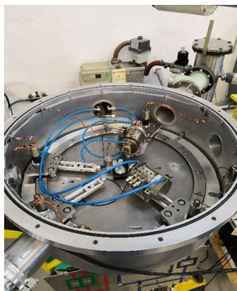
Foto 5. Sistemul de detector ( \Delta E-E ) de pe linia #4, sistem complet automat controlat din exterior.
